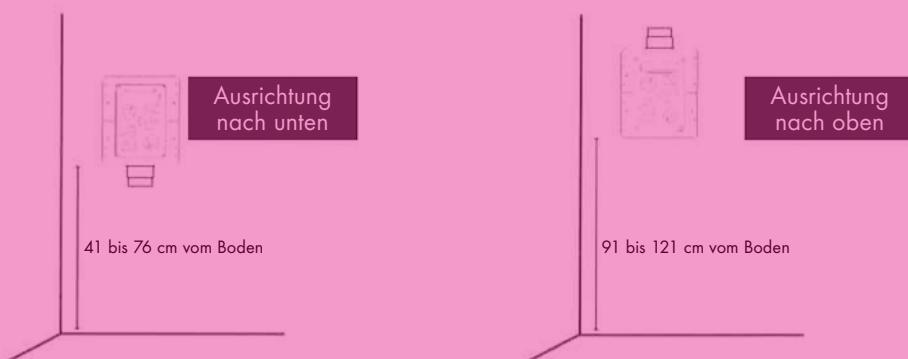
Wenn der Montagerahmen nach unten ausgerichtet eingebaut wird (der Schlauchanschluss nach unten zeigt), sollte zur Optimierung des Bedienkomforts der Abstand zwischen Montagerahmen (Unterkante) und Boden zwischen 41 und 76 cm betragen.
