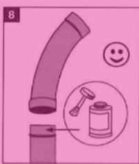
Etwige Schnittgrade oder überschüssiger Klebstoff in der Rohrleitung können dazu führen, dass der Schlauch beim Herausziehen oder sich weder zurückziehen daran hängen bleibt oder beschädigt wird. Um dies zu verhindern, sollte der PVC-Kleber nur auf die Außenseite des Anschlusses und nicht auf die Innenseite aufgebracht werden (Abb. 8).
