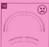
Nur Rohrbögen, die speziell für Schlauch-einzugsysteme ausgelegt sind, dürfen für die Rohrleitungsabschnitte verwendet werden, in der der Schlauch einzug erfolgt (Abb. 9).
