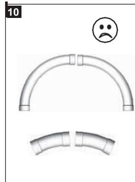
Es importante hacer un circuito de tubos de PVC que permite colocar la manguera en una sola planta (figura 11). Evitar una instalación realizada en dos plantas (figura 12).
