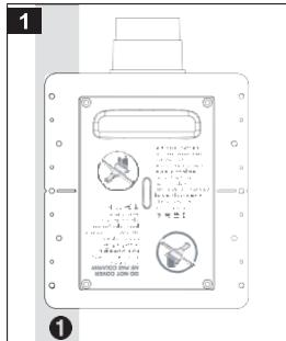
Befestigen Sie den Rahmen der Saugdose an den Wandpfosten (2x4). Versichern Sie sich, dass die Saugdose senkrecht ist (Abbildung 1), und dass hinter der Saugdose 8 cm bleiben.
