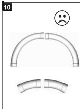
E' importante creare una rete tubiera che permetta di collocare il tubo flessibile su un unico livello (figura 11). Evitare l'installazione su 2 livelli (figura12).
